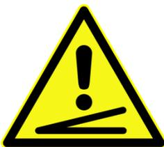
Die Neigung des Untergrundes darf maximal 7° betragen, um eine ausreichende Standsicherheit zu gewährleisten.
